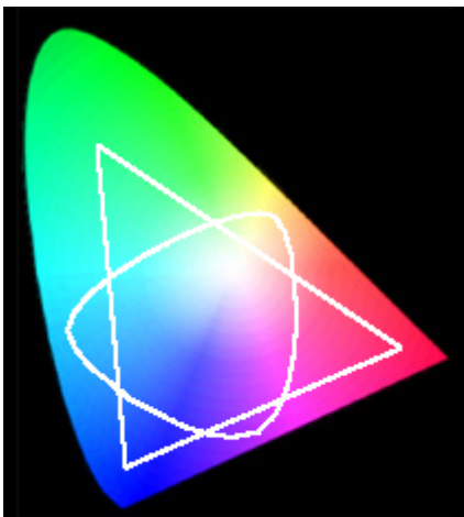
El gamut genérico de un monitor RGB comparado con el gamut genérico de un dispositivo de impresión CMYK.
