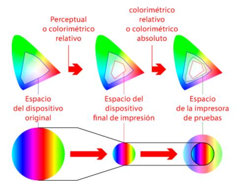
**Advertencia:** Para que la simulación (prueba de color) se pueda hacer, el espacio de color que describe la combinación de A, B y C (el aparato de pruebas) tiene que tener mayor rango cromático, que el que describe la combinación de E, D y F. Si no, la prueba será errónea.
